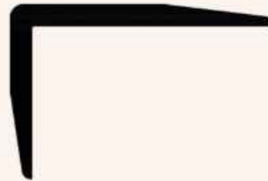
KAPLAMALI ( FOLYOLU ) L KÖŞE ( L EDGE CLOSURE )
